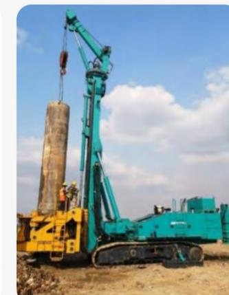
▲ SWRC170H 自行式全回转全套管钻机
